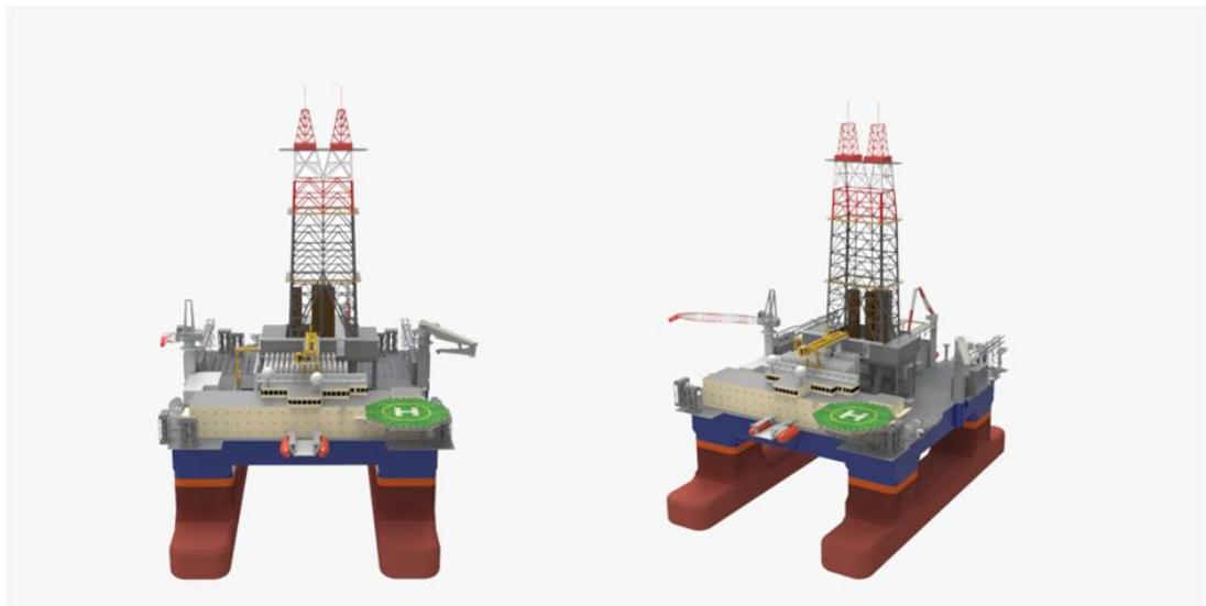
Slika 8. Shematski prikaz poluuronjive platforme (Semi-Submersible Drilling Rig)
