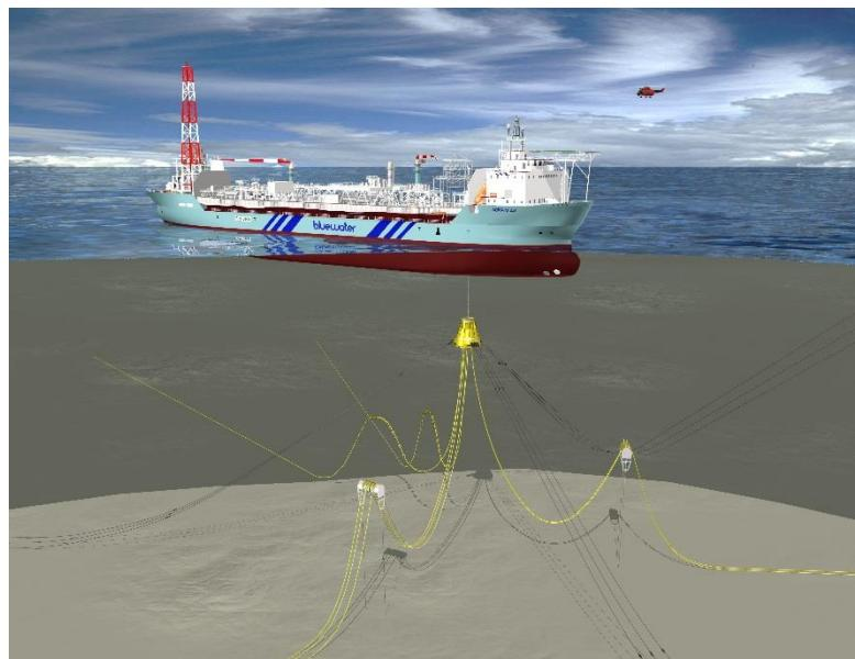
Slika 13. Shematski prikaz plutajućeg dinamički pozicioniranog broda za eksploraciju, skladištenje i otpremu ugljikovodika
