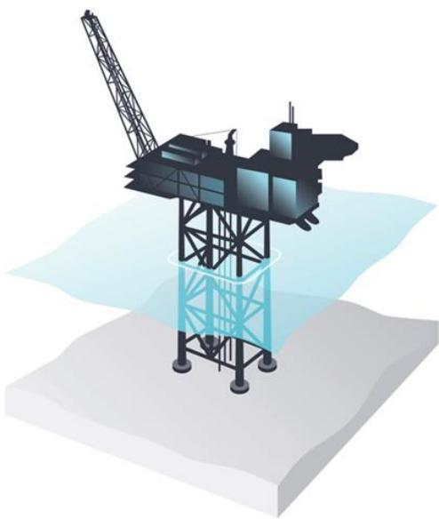
Slika 11. Shematski prikaz fiksne platforme za eksplotaciju ugljikovodika
