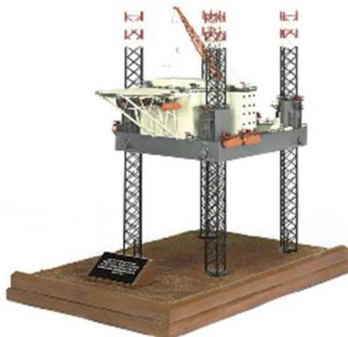
Slika 6. Shema sapomodižuće bušaće platforme (Jack-up drilling rig)
